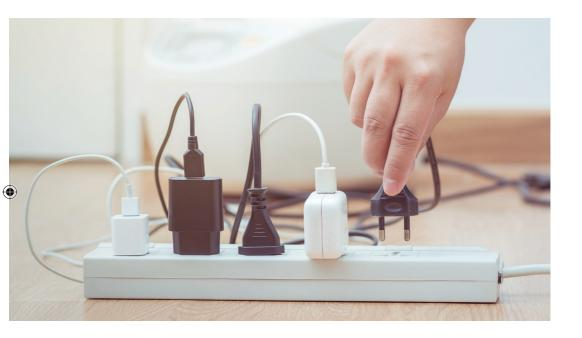
Različni polnilci (za prenosne računalnike, mobilne telefone itd.) še naprej porabljajo električno energijo tudi, ko jih ne uporabljamo, če ostanejo priključeni v vtičnico. Ena od priročnih rešitev je uporaba podaljška z več vtičnicami s stikalom za izklop, ki omogoča enostaven izklop več naprav naenkrat.
